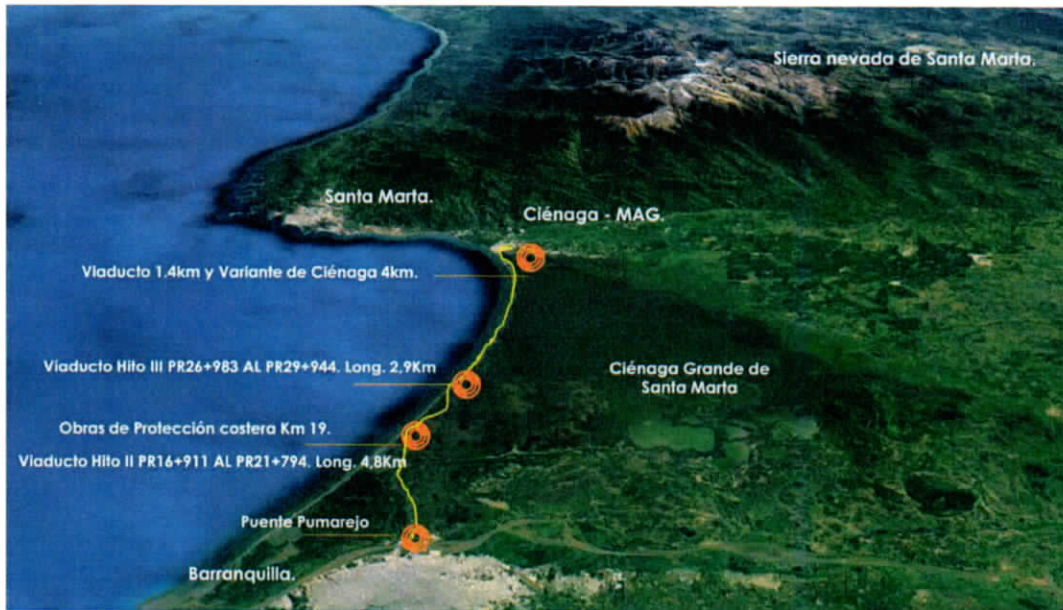
Grafica No. 3. Ubicación de sitios críticos que impactan el corredor vial, “TRONCAL DEL CARIBE” el departamento del magdalena por el fenómeno de erosión costera
